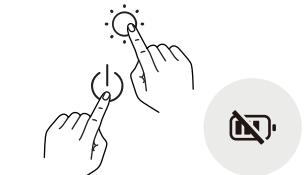
Astuce : Lorsque l'appareil est branché à l'alimentation secteur, il utilise le transformateur électrique pour alimenter et charger la batterie ; lorsque l'alimentation secteur est coupée, l'appareil active automatiquement l'alimentation par batterie. L'ensemble de l'appareil s'éteint lorsque la batterie est épuisée.
