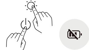
Nota: Despues de conectar a la electricidad, la unidad utiliza el adaptador de corriente para suministrar energía y cargar la batería. Cuando se desconecta la electricidad, la batería se enciende automáticamente. Una vez agotada la batería, la unidad se apagará.
